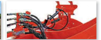
Optional hydraulische Klappung der Randbleche
