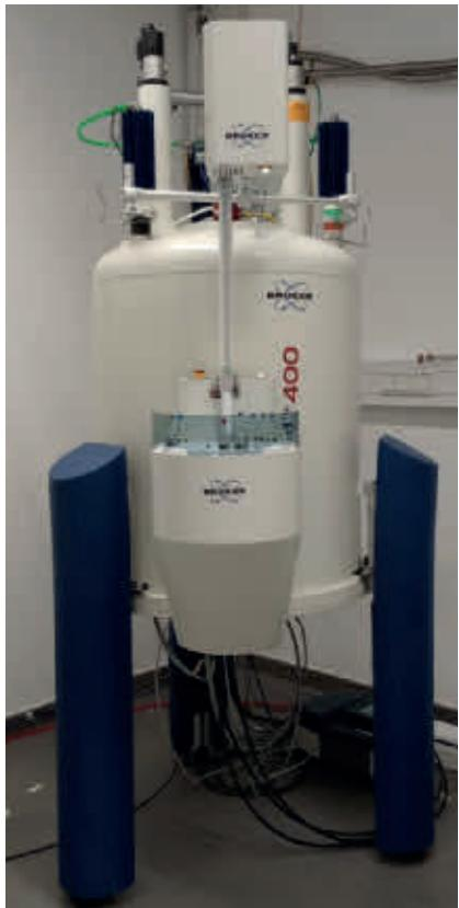
Abb. 1: Aufbau eines klassischen NMR-Spektrometers (Quelle: RPTU Kaiserslautern)
