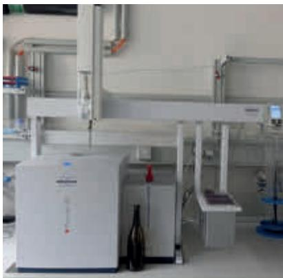
Abb. 2: Ein „Benchtop“-NMR Gerät passt problemlos auf eine Laborbank.
