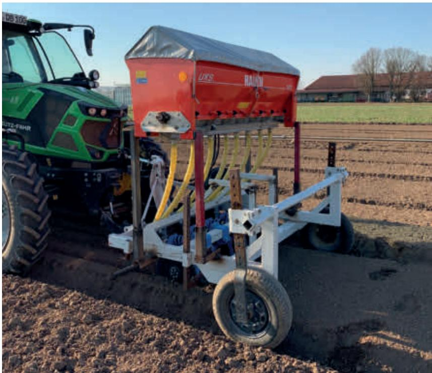
Abb. 1: Düngetechnik zur Ausbringung Unterfuß
