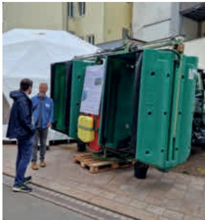
Abb. 3: Pflanzenschutzgerät mit Recyclingtechnik
