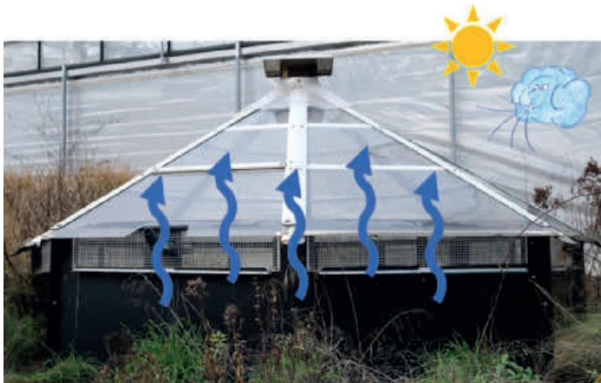
Abb. 1: RemDry™-System: Sonneneinstrahlung und Wind fördern die Verdunstung des Wassers.
