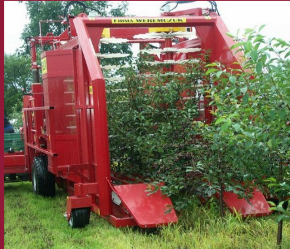
Erntemaschine Weremczuk Felix Z für kleinkronige Baumformen (4x1,5-2 m)
